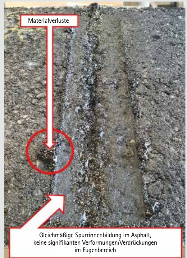
Bild 17: Bitumenheißvergussmasse im Spurbildungsversuch bei 50 °C
