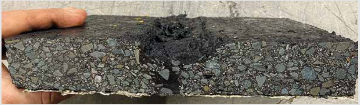
Bild 16: Spurbildungsversuch bei 60 °C nach Erreichen des Abbruchkriteriums
