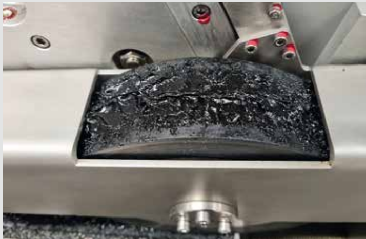
Bild 17: Bitumenheißvergussmasse im Spurbildungsversuch bei 50 °C
