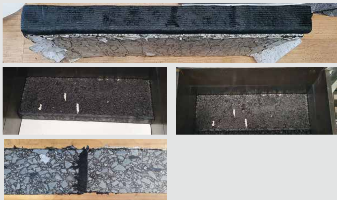
Bild 15: Herstellung einer Asphalt-Probeplatte mit Längsfuge und Bitumenfugenband
