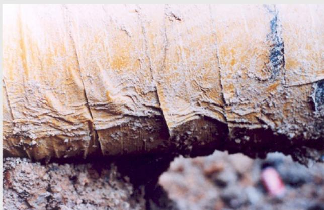
**Bild 4:** Versagen von laminierten 2-Schichten-Bändern – Schwache Zugscherfestigkeit: schwache Widerstandsfähigkeit gegenüber Bodenspannungen
