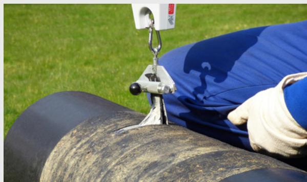
**Bild 5:** Übertoller Korrosionsschutz: koextrudierte Bänder – Kohäsives Trennbild nach 39 Jahren im Feld
