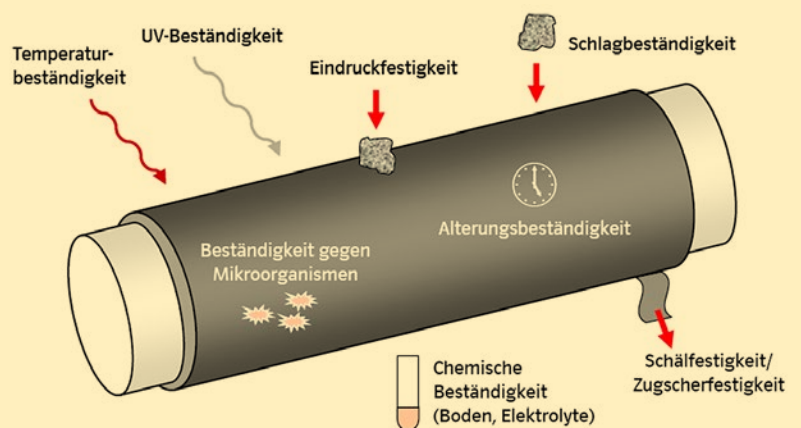
Bild 3. Belastungen, die auf Rohrumhüllungen wirken.
