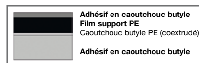
Structure DENSOLEN®-N60 et DENSOLEN®-S20 (épaisseurs différentes)
