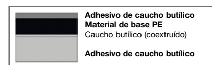
Composición de DENSOLEN®-N60 y DENSOLEN®-S20 (diferentes espesores)
