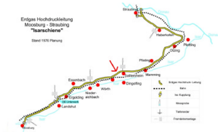
Bild 3: Ausbauort der Leitungsabschnitte Fig. 3: Dismounting location of pipe segments.
