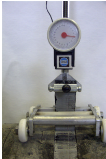
Bild 9: Schälversuch mit Handfederwaage bzw. autom. Schälgerät.
