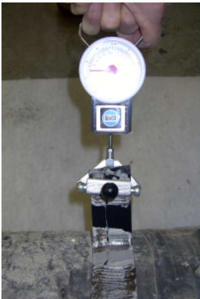
Bild 9: Schälversuch mit Handfederwaage bzw. autom. Schälgerät.
