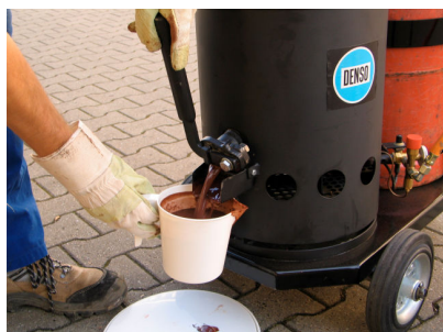
b) Einfüllen der geschmolzenen DENSO KS-Masse in einen Zwischenbehälter
