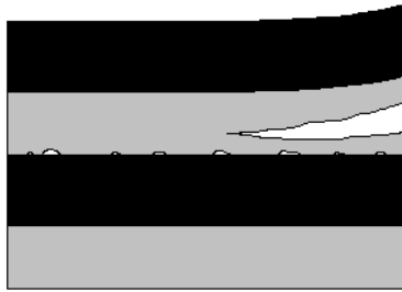
Abb. 8: Kohäsionsbruch beim Abschälen von Zweischichtbändern
