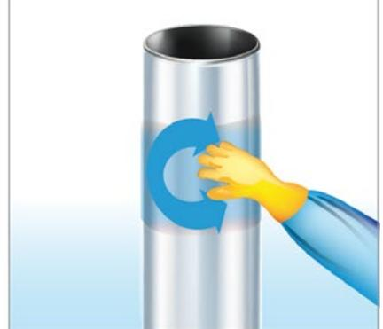
■ Appliquez le primaire **MarineProtect®-Primer** sur la surface nettoyée à la main, au rouleau ou à l'aide d'une spatule. Assurez-vous que la totalité de la surface est recouverte de **MarineProtect®-Primer**. La quantité nécessaire de **MarineProtect®-Primer** est environ de 350 g/m<sup>2</sup>.
