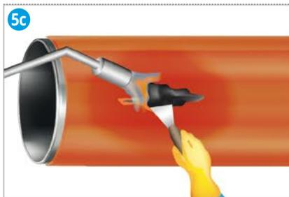
**5c Remplissage du défaut avec DEXPAND® Filler (REP HT)**
