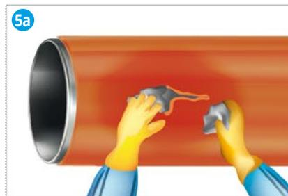
**5a Remplissage du défaut avec DEXPAND®-Mastic (REP MT)**
