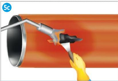
**5c Relleno del defecto con DEXPAND®-Filler (REP HT)**
