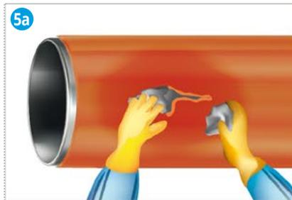
**5a Relleno del defecto con DEXPAND®-Mastic (REP MT)**
