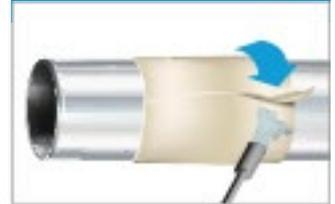
Recubrir las zonas encintadas con la cinta de **Petrolatum DENSO®** con una capa de manta anti-roca **DEPROTEC®-DRM PP** hasta el revestimiento de fábrica adyacente. Fijar la manta en la zona de solape mediante una llama y presionarla firmemente. Como protección mecánica adicional puede utilizarse la cinta de fibra de vidrio **DEPROTEC®-PUR**.
