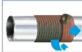
Enrollar la cinta de **Petrolatum DENSO®** sobre la tubería con el solape requerido, de forma espiral y evitando pliegues o arrugas. A continuación, alisar y presionar firmemente la cinta de **Petrolatum DENSO®** con la mano.
