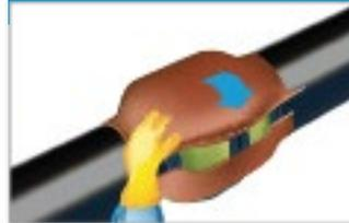
Aplicar la cinta de **Petrolatum DENSO®** de forma que quede centrada sobre la brida, y modelarla sobre la circunferencia exterior, las cabezas de tornillo, las tuercas, etc. El ancho de la cinta depende del diámetro nominal: 250, 300 o 400 mm.
