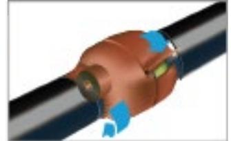
Aplicar la cinta de **Petrolatum DENSO®** en 2 capas alternando entre los bordes derecho e izquierdo de la brida. La longitud de los recortes de la cinta de **Petrolatum DENSO®** se corresponden con la circunferencia exterior de la brida más 50 mm para el solapamiento. Revestir la superficie adyacente en ambos lados de la brida con la cinta de **Petrolatum DENSO®** en forma de manguito o espiral.
