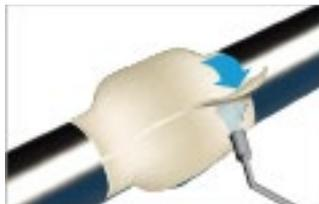
Recubrir las zonas encintadas con la cinta de **Petrolatum DENSO®** con una capa de manta anti-roca **DEPROTEC®-DRM PP** hasta el revestimiento de fábrica adyacente. Fijar la manta en la zona de solape firmemente. Como protección mecánica adicional puede utilizarse la cinta de fibra de vidrio **DEPROTEC®-PUR**.
