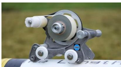
**DENSOMAT®-1** couvre la plupart des domaines d'application elle est souvent assimilée à une machine d'enrobage universelle. La **DENSOMAT®-1** peut être utilisé dès le DN80 sur parties droites et sur des coudes dès le DN 100.
