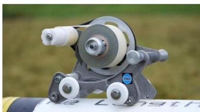
**DENSOMAT®-1** как универсальное намоточное устройство покрывает большинство областей применения. **DENSOMAT®-1** можно использовать для диаметров труб от DN80 на прямых трубах и от DN 100 на отводах труб.
