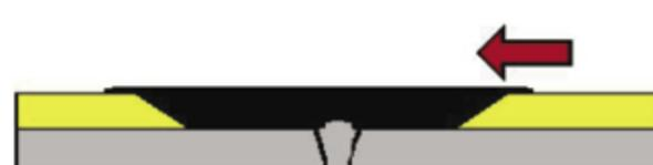
С точки зрения структурных особенностей система DENSOLID HDD является полиуретановым противокоррозионным покрытием для сварных стыков стальных труб, прокладываемых методом ГНБ.
