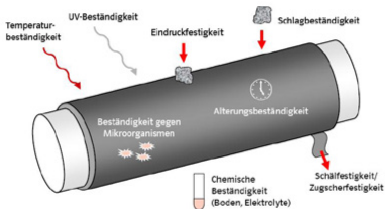
Bild 3: Belastungen, die auf Rohrumhüllungen wirken
