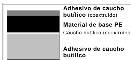
Sección esquemática de DENSOLEN®-AS30
