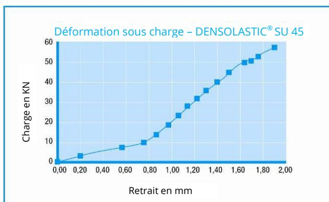
Détermination d'un module sécant entre 0 et 50 KN en tenant compte de la caractéristique d'élasticité.
